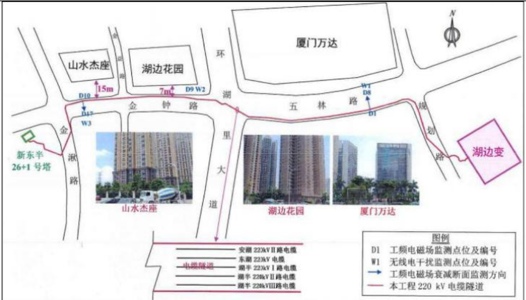
图 4-2 厦门湖边 220kV 变电站配套 220kV 线路工程监测布点图
