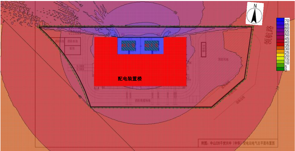
图4-1 变电站厂界噪声预测等值线图
