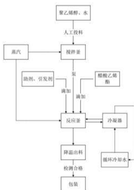
图2.2-1 聚醋酸乙烯酯乳液生产工艺流程
