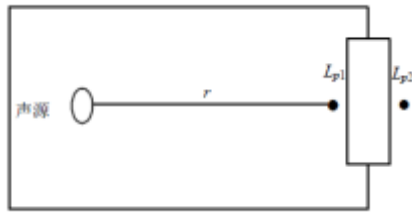
图 6.5-1 室内声源等效为室外声源图例
