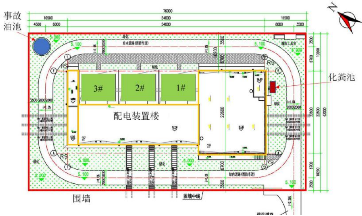
图 8-1 东莞 110 千伏大井头站电气平面布置图
