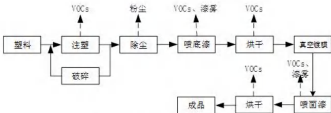
图 3.1-9 典型塑料加工生产工艺流程
