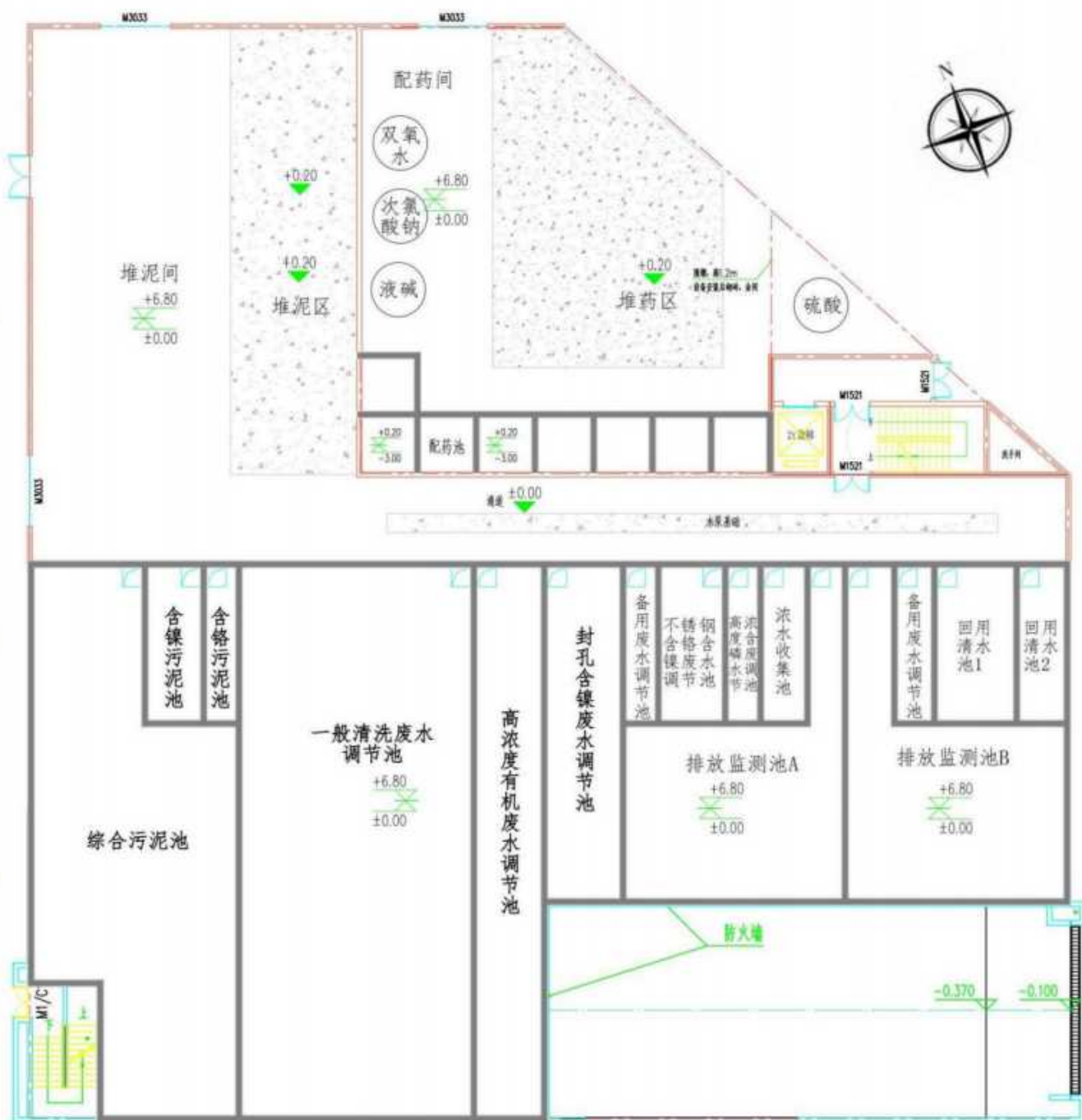
图 3.2-6 废水处理站建筑布局图（一层）
