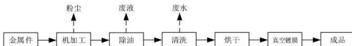
图 3.1-4 典型前处理-真空镀膜线生产工艺流程及产污节点
