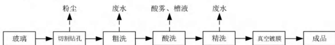
图 3.1-10 典型玻璃加工生产工艺流程
