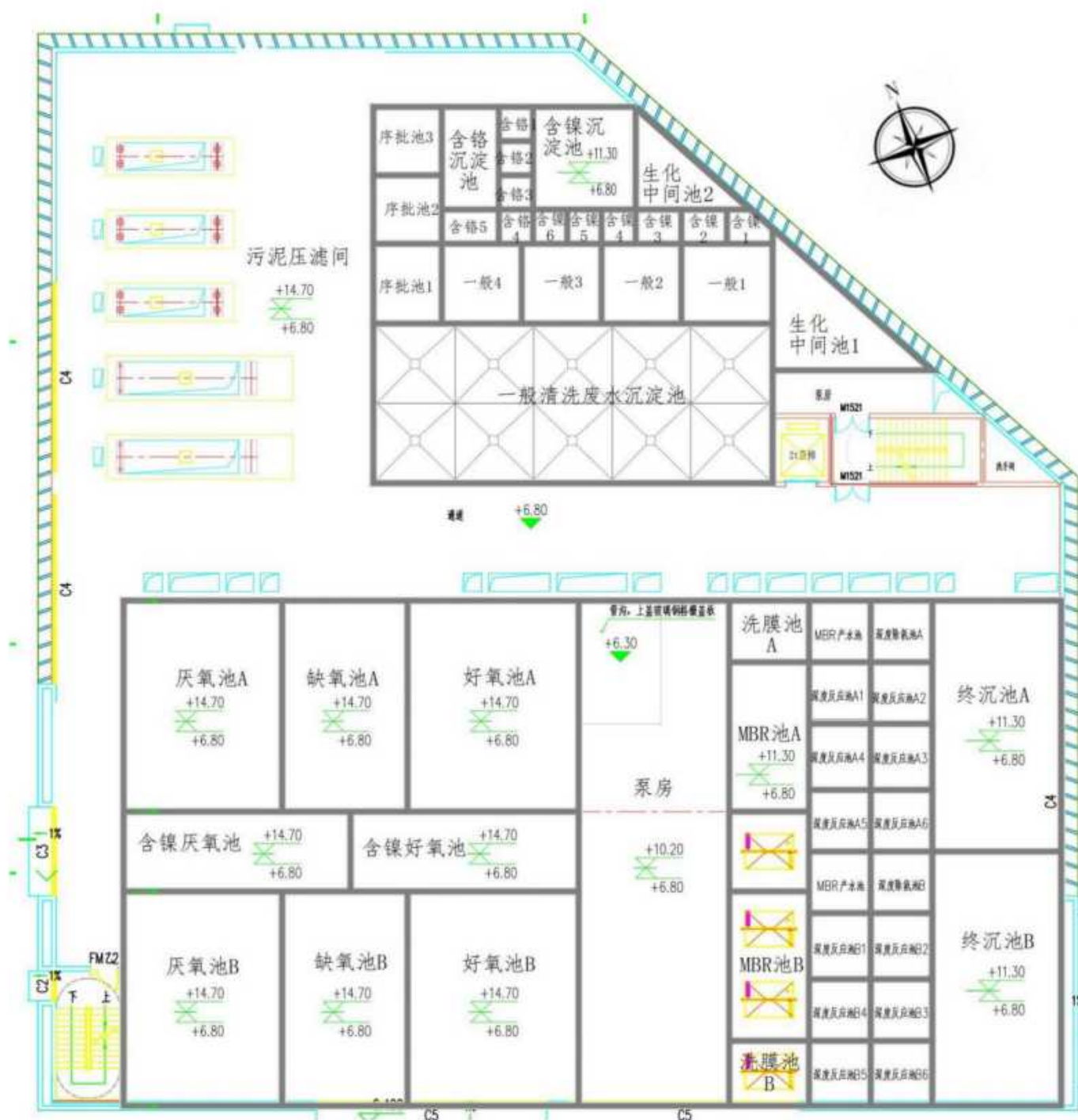
图 3.2-7 废水处理站建筑布局图（二层+6.80m）
