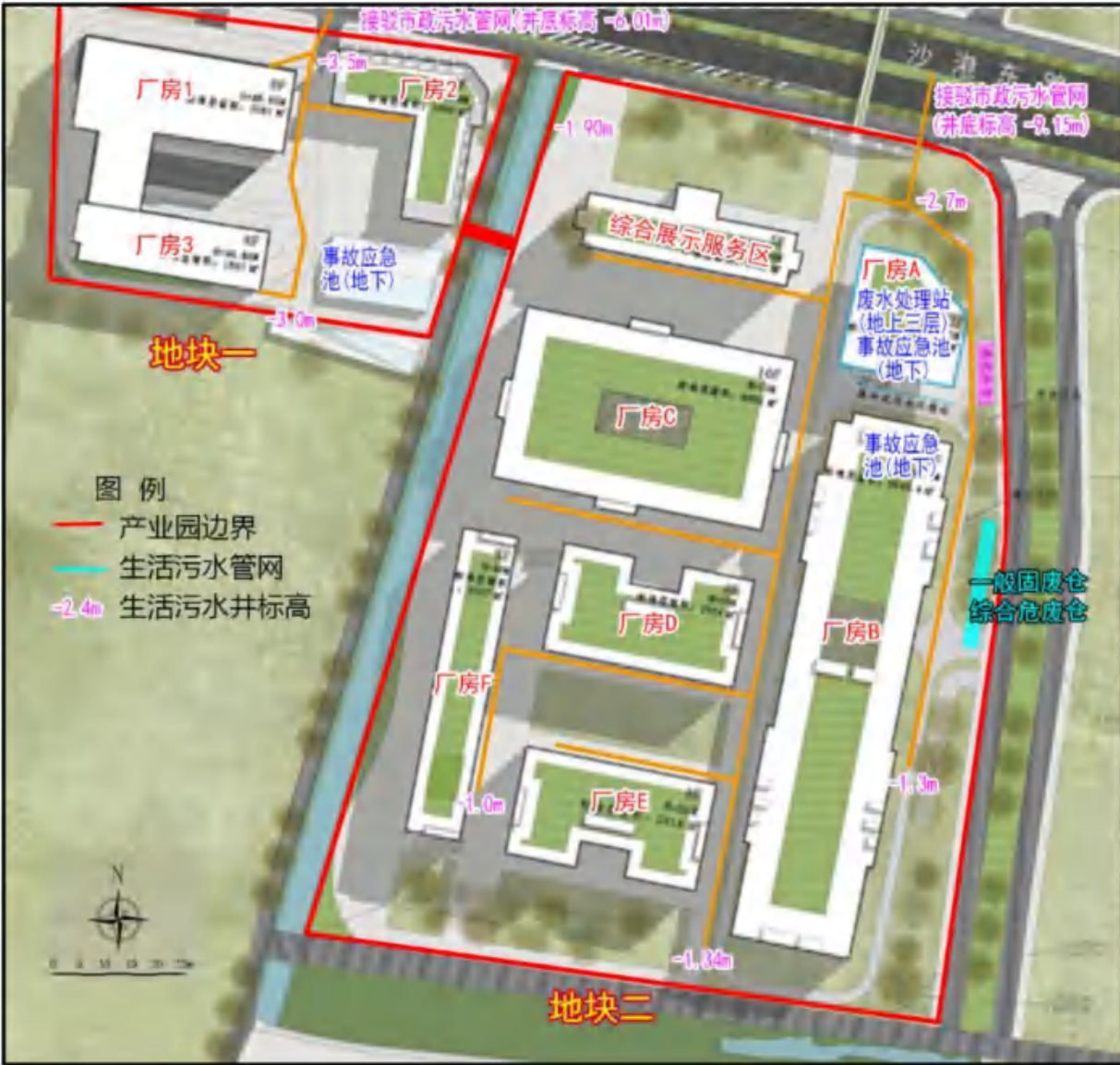
图 5.2-66 项目所在产业园生活污水管网图
