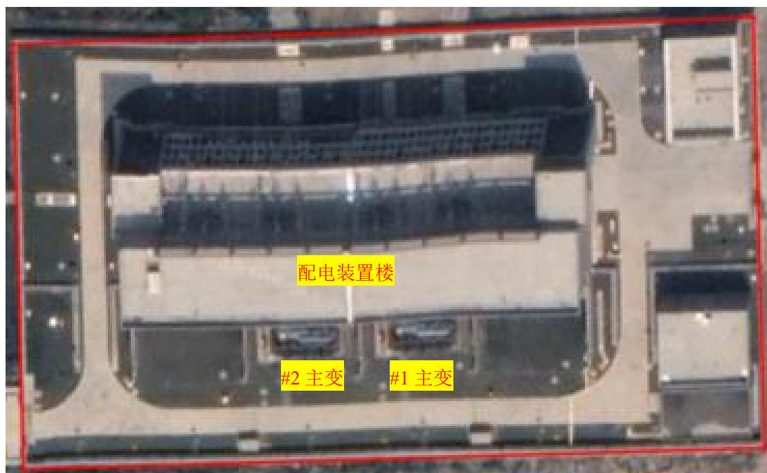
图 4-1 220kV 低涌变电站平面布置示意图
