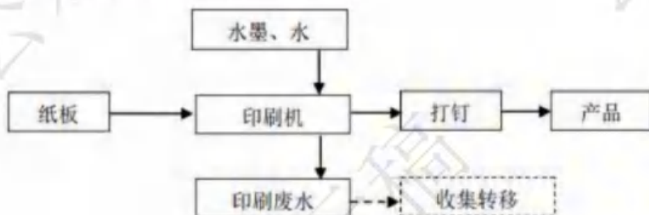
图 3.2-5 纸箱印刷行业废水产生工艺流程简图
