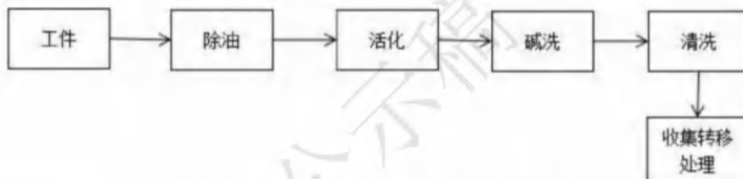
图 3.2-2 金属表面处理清洗废水产生工艺流程图
