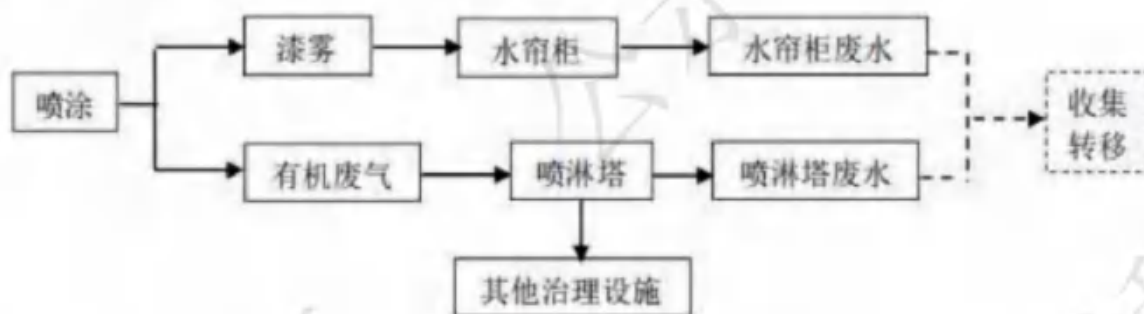
图 3.2-1 喷涂废水产生工艺流程图
