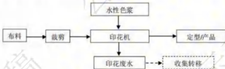
图 3.2-6 印花废水产生工艺流程图
