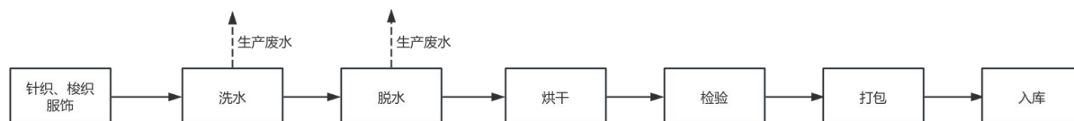
图 2-2 服饰生产工艺流程图
