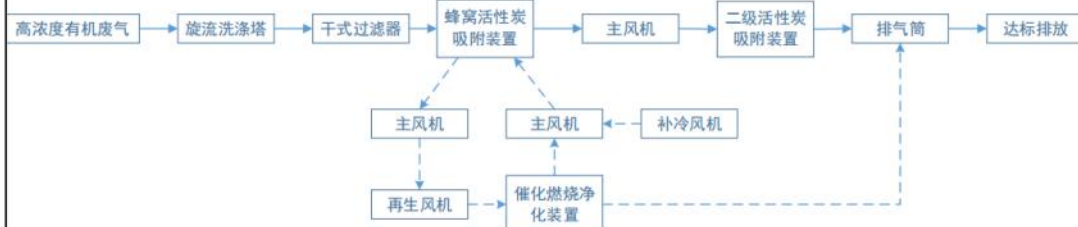
图3 高浓度有机废气治理工艺流程图
