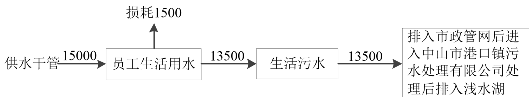
图 2 扩建部分水平衡图（单位为吨/年）
