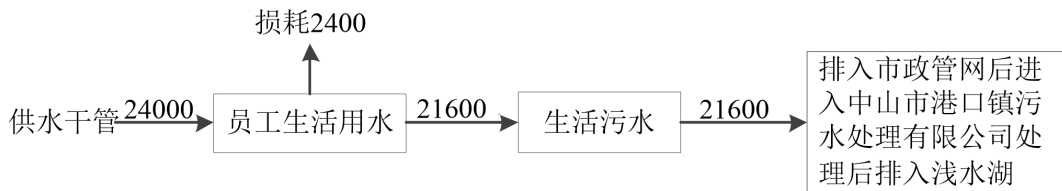
图 1 现有项目水平衡图（单位为吨/年）
