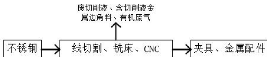
图 6 夹具、金属配件生产工艺流程图及产污环节图
