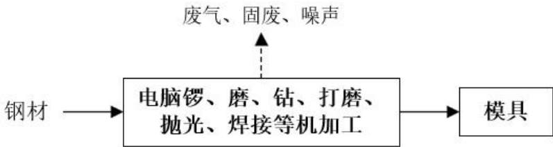
图 2-8 现有项目模具车间的生产工艺流程及产污环节图（工艺 2）
