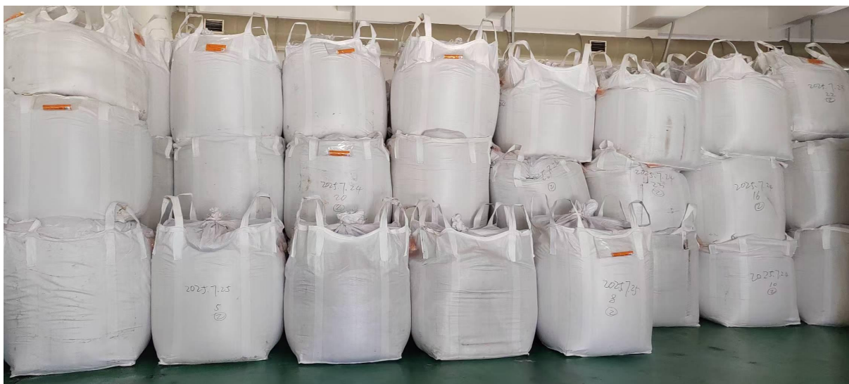
图 4.7-2 中山市南部组团垃圾综合处理基地垃圾焚烧发电厂飞灰处理物照片（飞灰处理物呈松软潮湿的团状结构、吨袋密封包装暂存于养护区）
