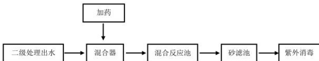
图 8.1-3 中山市小榄水务有限公司污水处理分公司三期工程深度处理工艺流程
