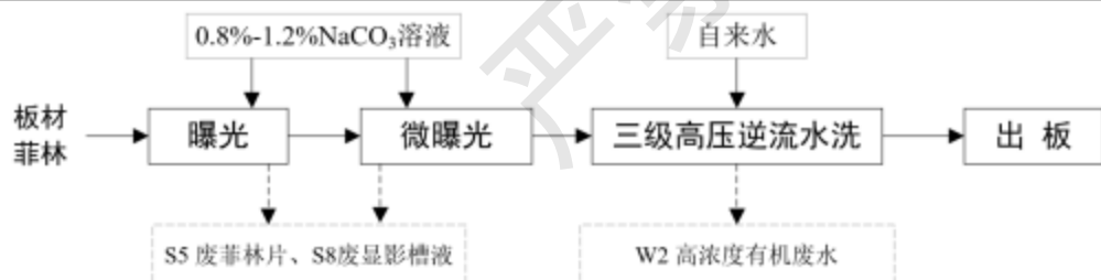
图 2-4 项目曝光显影的生产工艺流程及产污环节图
