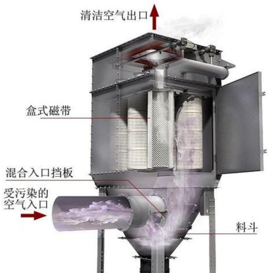
图7-1滤筒除尘器示意图
