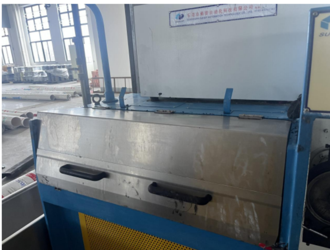
图 8.1-3 拉丝机有机废气收集示意图（密闭作业）
