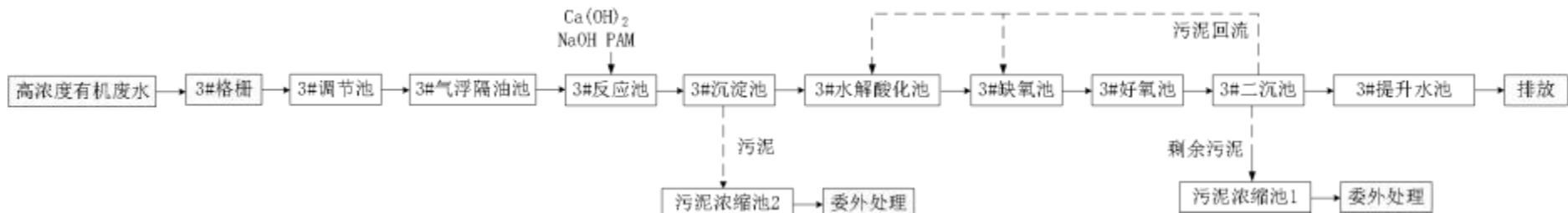
图 8.1-3 产业园污水站处理工艺流程示意图
