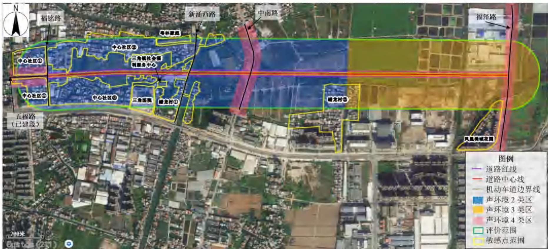
图 2.2-1 本项目建设前声环境保护目标及 4a 类声环境功能区分布图
