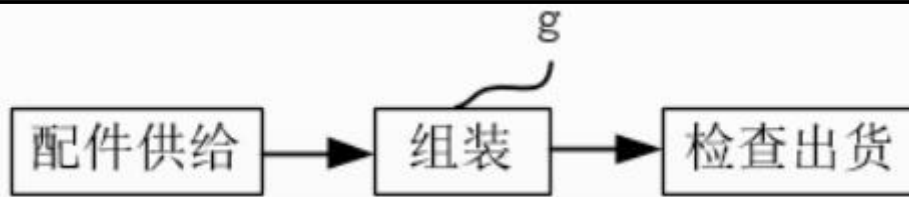
图 2-8 原环评 ABS 工艺流程及产污环节图
