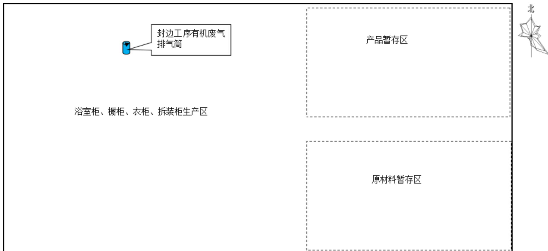
附图四：项目四层家具生产车间平面布置图（比例尺：1:500）
