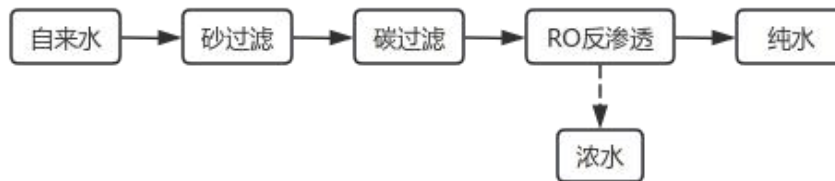
图 5 纯水制备工艺流程图
