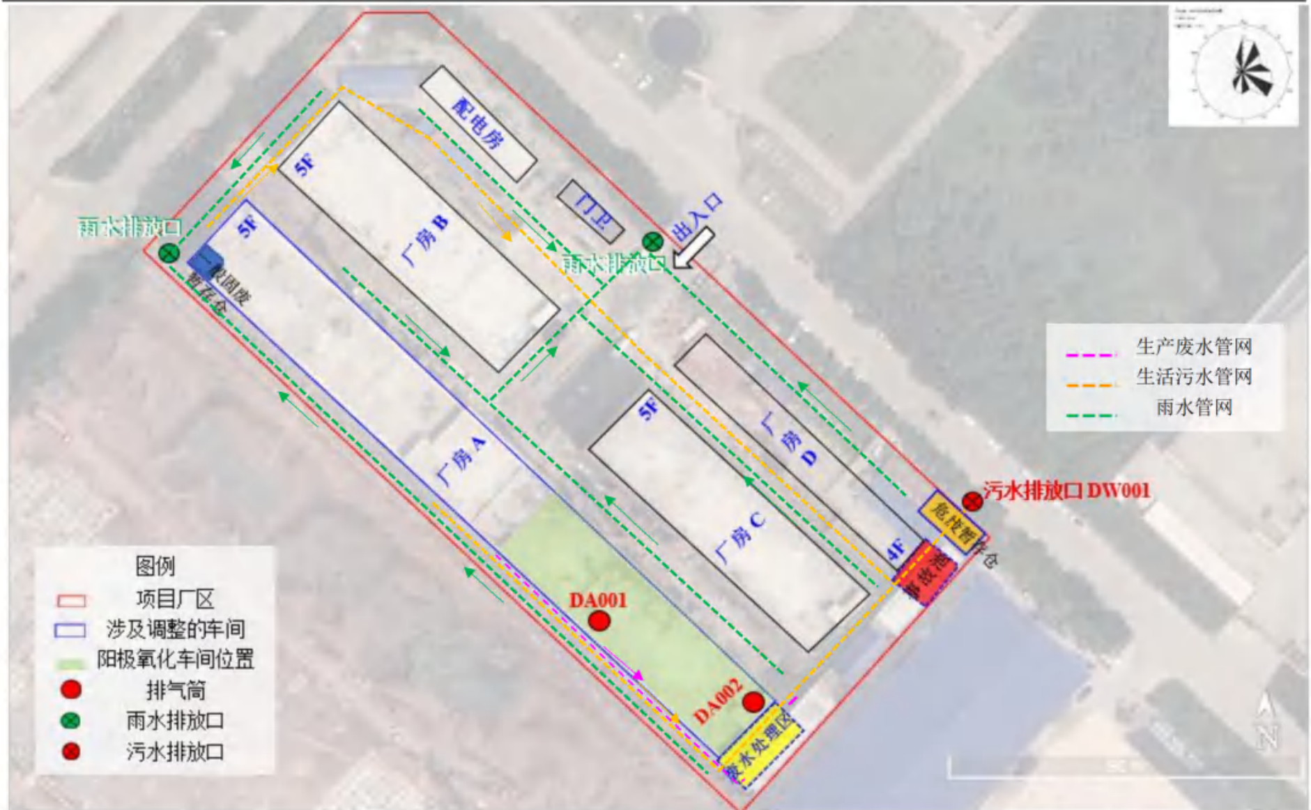
图 3.1.8-1 项目所在厂区雨、污（废）水管网图
