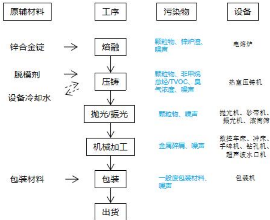
图 2-2 本项目产品的生产工艺流程图
