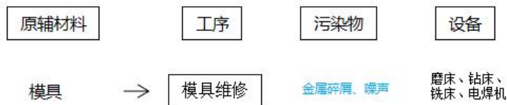
图 2-3 本项目模具维修流程图
