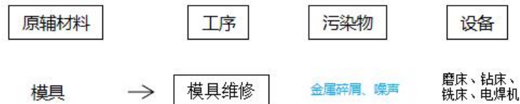
图 2-5 原有项目模具维修流程图
