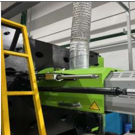
图3 注塑废气收集方式示例图
