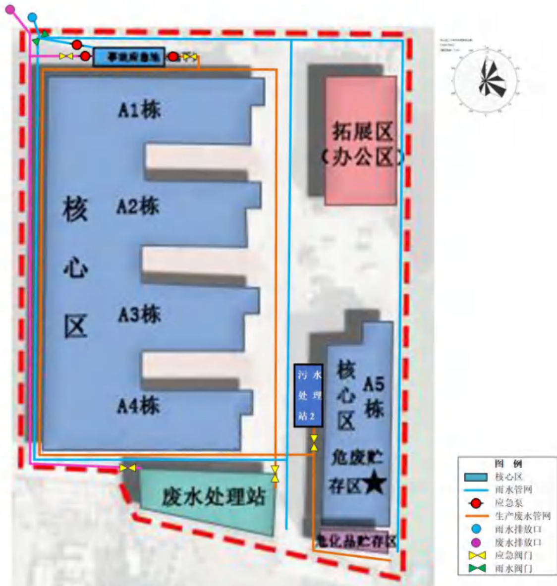
图 5.7-2 雨污管网图及封堵措施图
