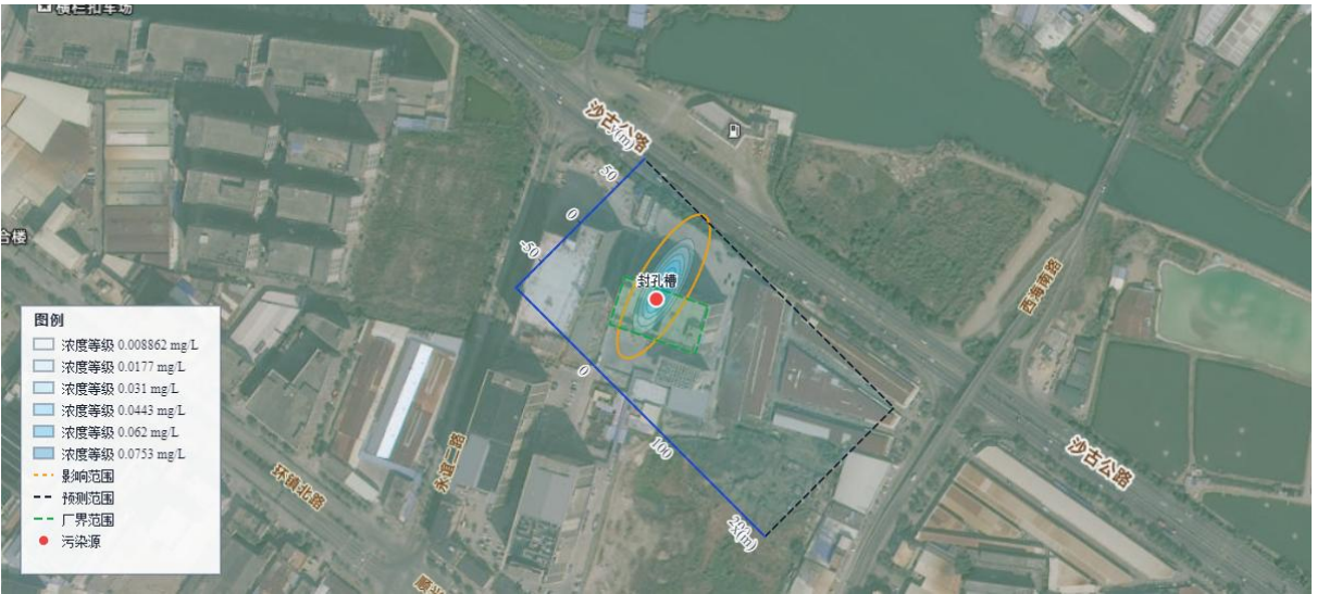
图 6.3-3 封孔槽-镍 t=1000 d 浓度等值线图
