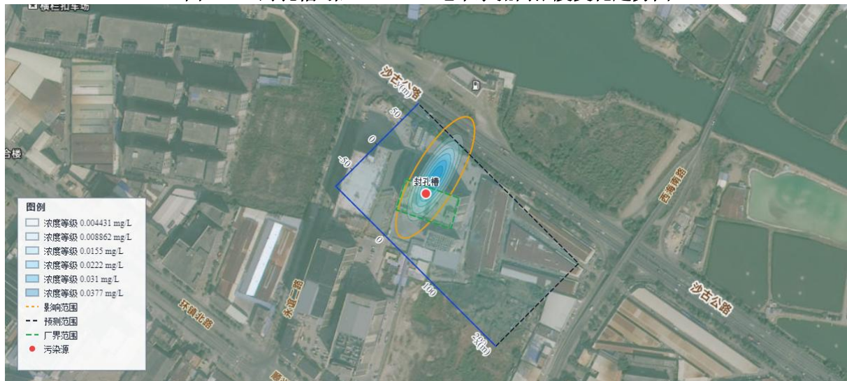
图 6.3-5 封孔槽-镍 t=2000d 浓度等值线图
