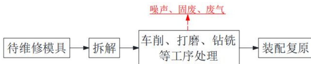
图8 模具维修工艺流程图
