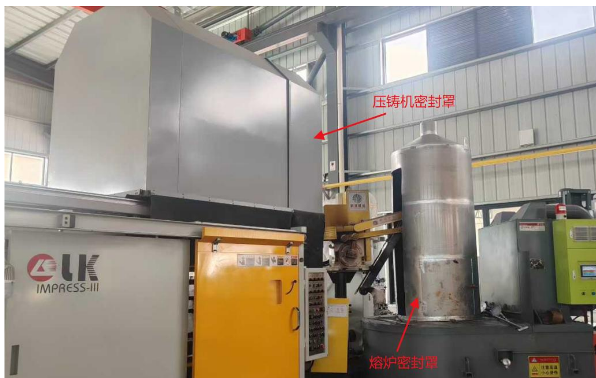
压铸机及熔炉集气罩设置示意图（由工程设计单位提供的其他企业工程实例图片）
