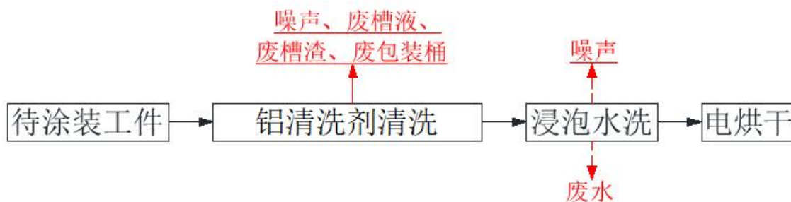
图6 喷漆工件涂装前除油清洗工艺流程图
