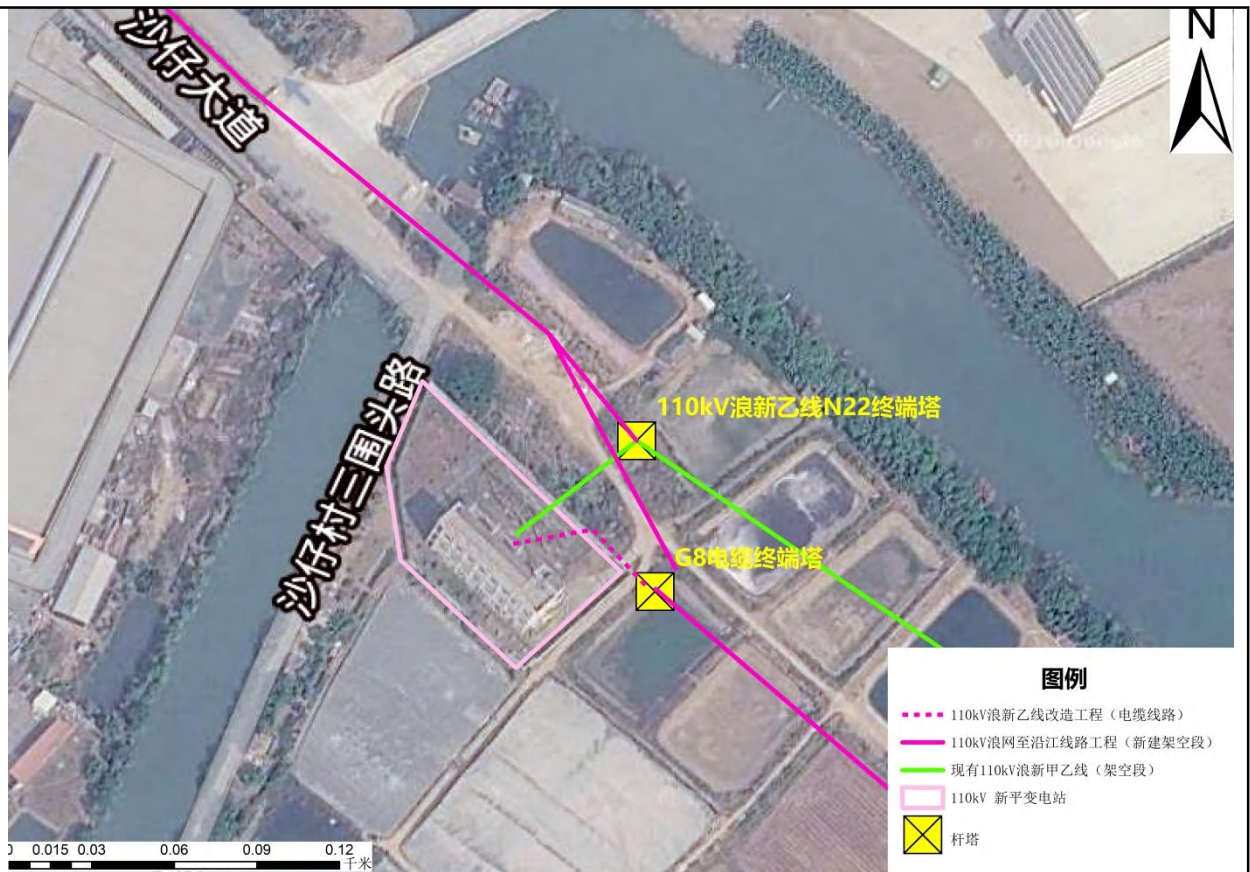
图 2-5 (1) 110kV 浪新乙线改造工程路径卫星图
