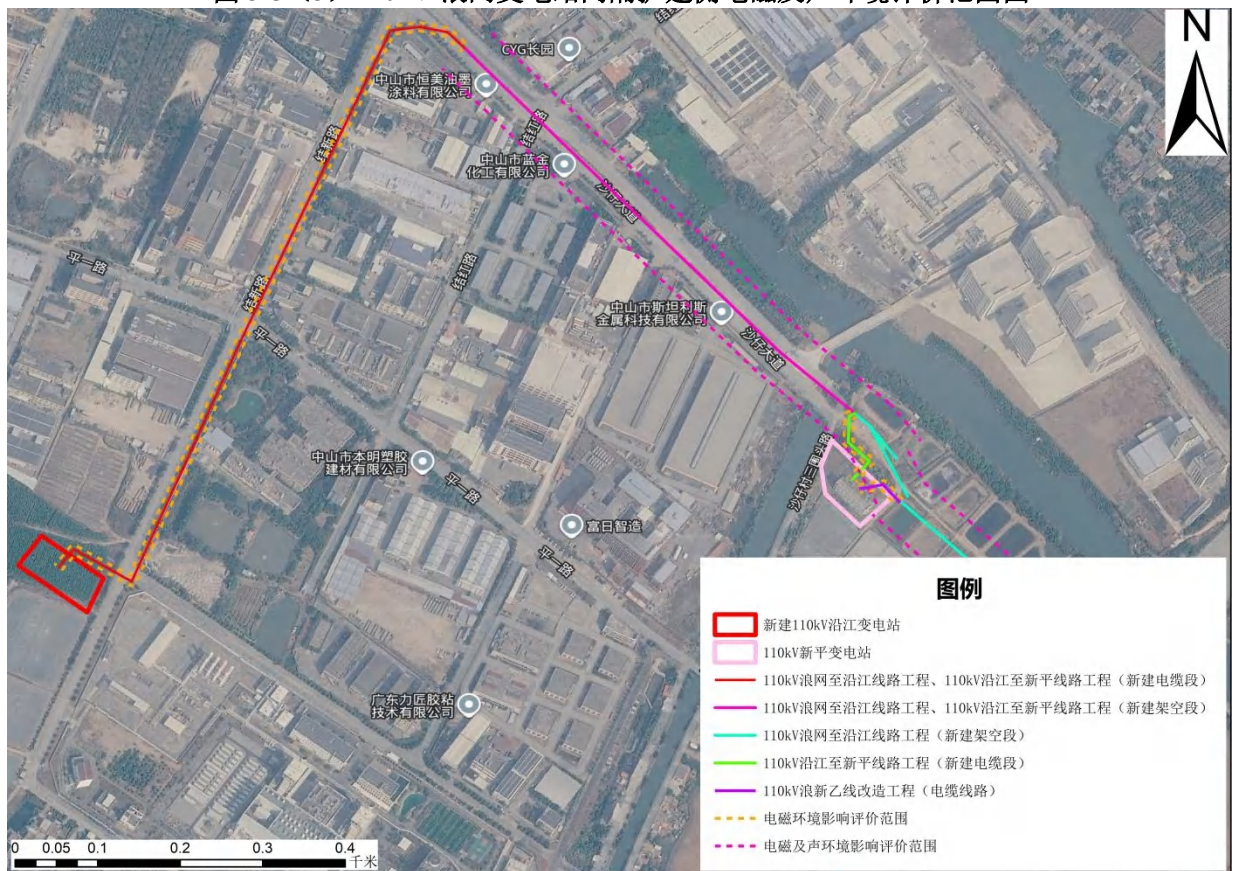
图 3-5 (4) 110kV 浪网至沿江线路工程、110kV 沿江至新平线路工程、110kV 浪新乙线改造工程电磁及声环境影响评价范围图
