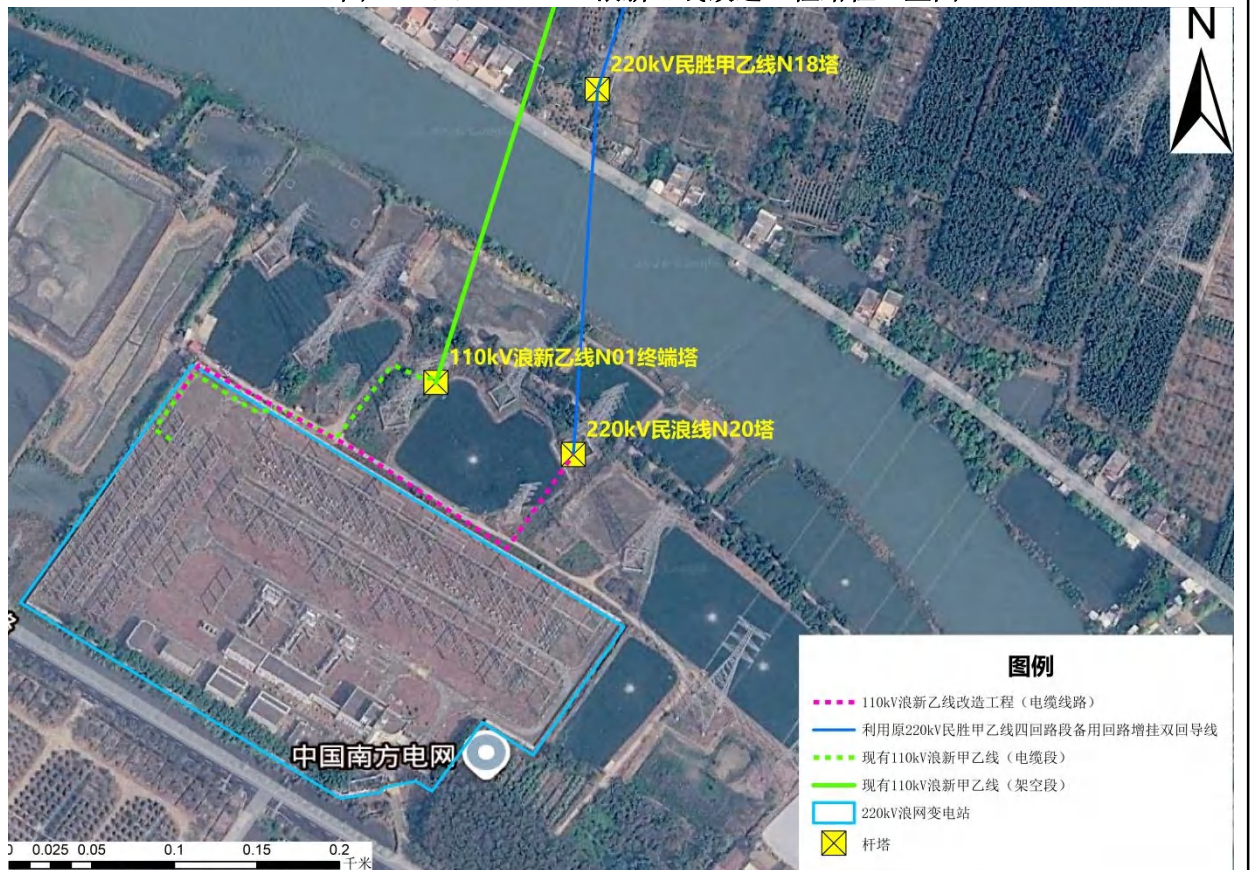
图 2-5 (2) 110kV 浪新乙线改造工程路径卫星图
