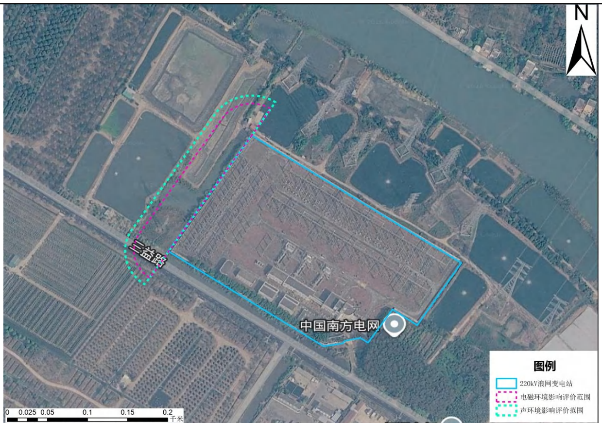
图 3-5 (3) 220kV 浪网变电站间隔扩建侧电磁及声环境影响评价范围图
