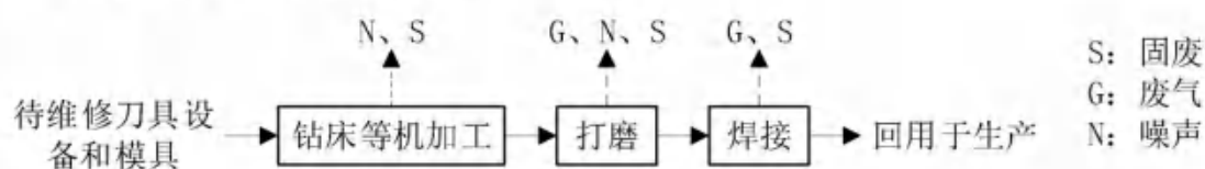
图 15 模具、刀具和机械维修工艺生产工艺流程图
