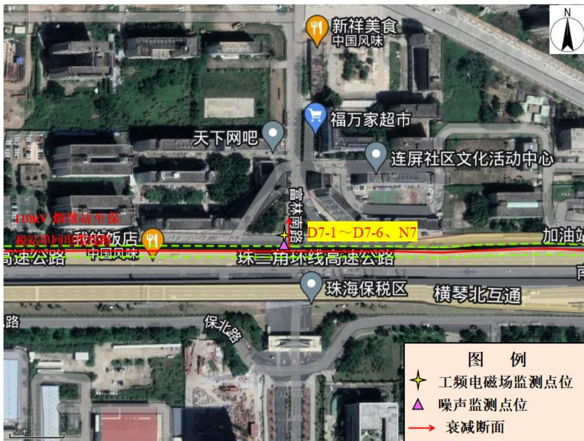
图 8-4 电缆衰减断面监测布点示意图
