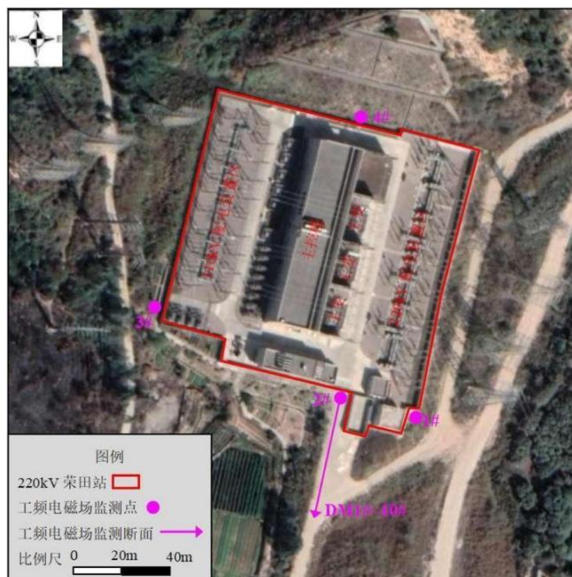
图 1 惠州 220kV 荣田变电站类比监测布点图
