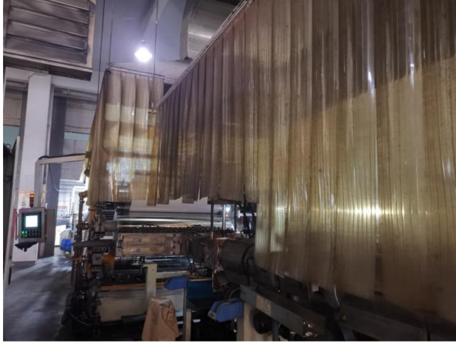
图 3 现有项目挤板设备集气罩+垂帘现场设置情况
