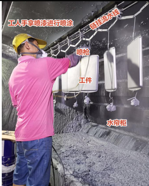
车间一喷漆挂线喷涂设备示意图
