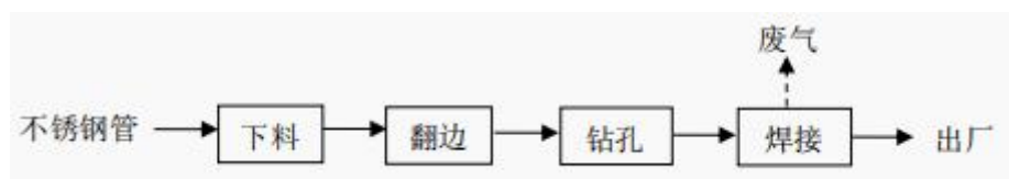
图7 不锈钢分配器组件工艺流程图
