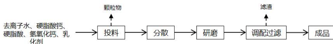
图 6 硬脂酸钙乳液生产流程图
